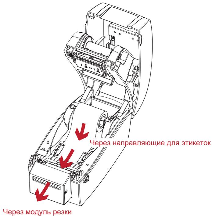
2. Закройте верхнюю крышку и механизм печати. В завершение нажмите кнопку подачи для установки положения этикетки.
