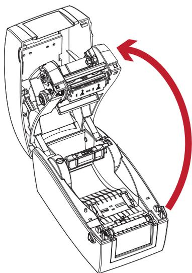
Механизм печати поднимается вверх вместе с крышкой принтера
