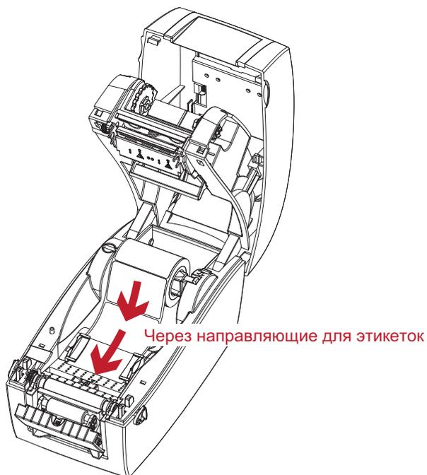
3. Протяните подложку этикеток через валик и стальную пластину этикетировочной машины.
