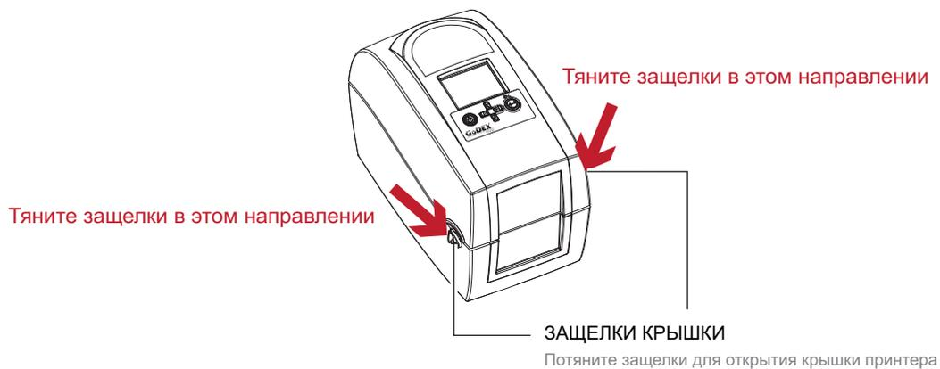
Поднимите крышку принтера назад
