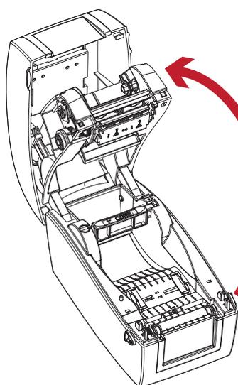
Механизм печати поднимается вверх вместе с крышкой принтера
