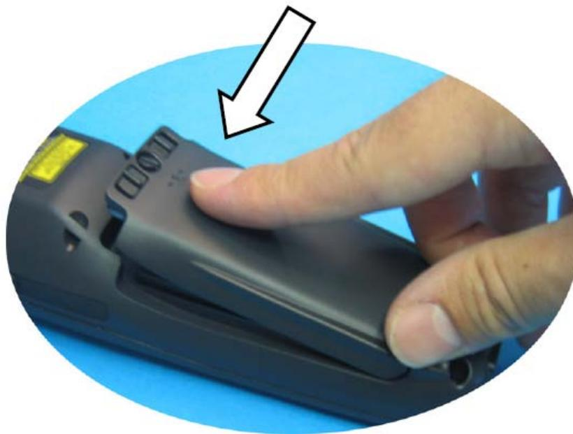
5. Для фиксации крышки передвиньте зажимы от винта, который также необходимо повернуть в горизонтальное положение.
