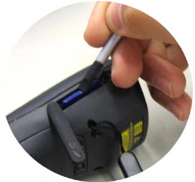
Для того, чтобы вынуть карту памяти из терминала, нажмите на нее вновь, помогая себе задним концом стилуса, до характерного щелчка. При этом система пружин вытолкнет карту памяти из слота.
