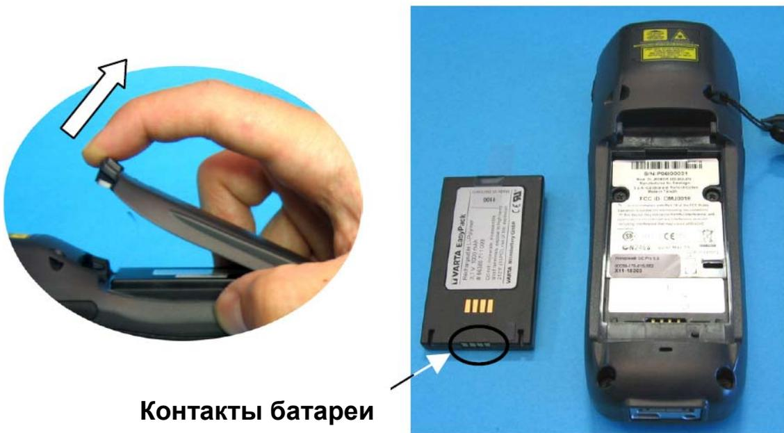
4. Установите новую аккумуляторную батарею, затем положите крышку отсека, в первую очередь установив нижнюю сторону крышки, затем верхнюю, как показано на рисунке:
