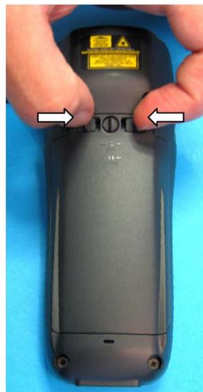
3. Снимите крышку отсека и удалите аккумуляторную батарею;
